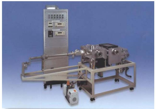
あおり式基板搬送システム採用例（FED評価装置）
