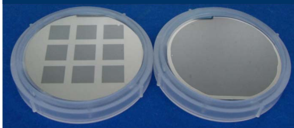
接合事例:Si/サファイアウエハ(2パターン)
