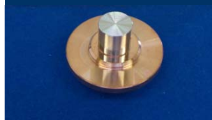
接合事例:Cu/SUS材
